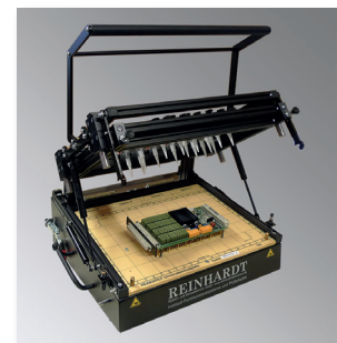
Adapter Typ 42A-2, bis zu 1000 Nadeln, Nutzfläche 360 x 230 mm
