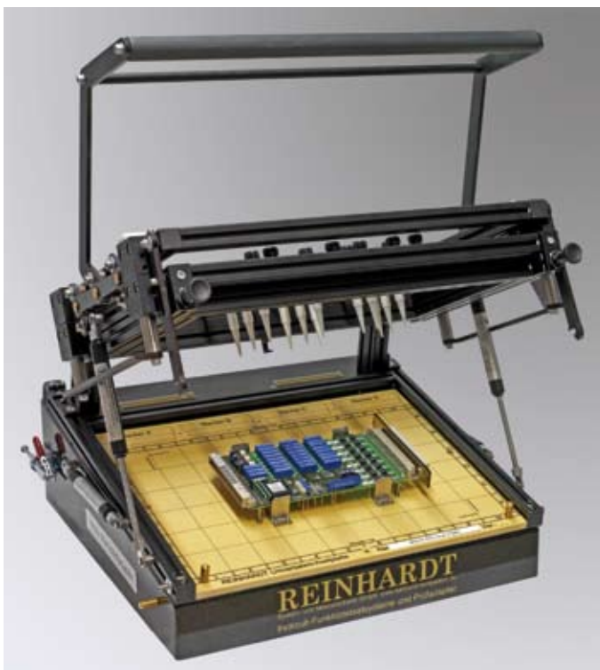
Adapter Typ 42A, max. 800 Prüfkontaktstifte, auch beidseitig, Nutzfläche 360x230 mm
