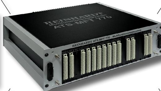
*In-Circuit-Funktionstestsystem ATS-MFT 770*
